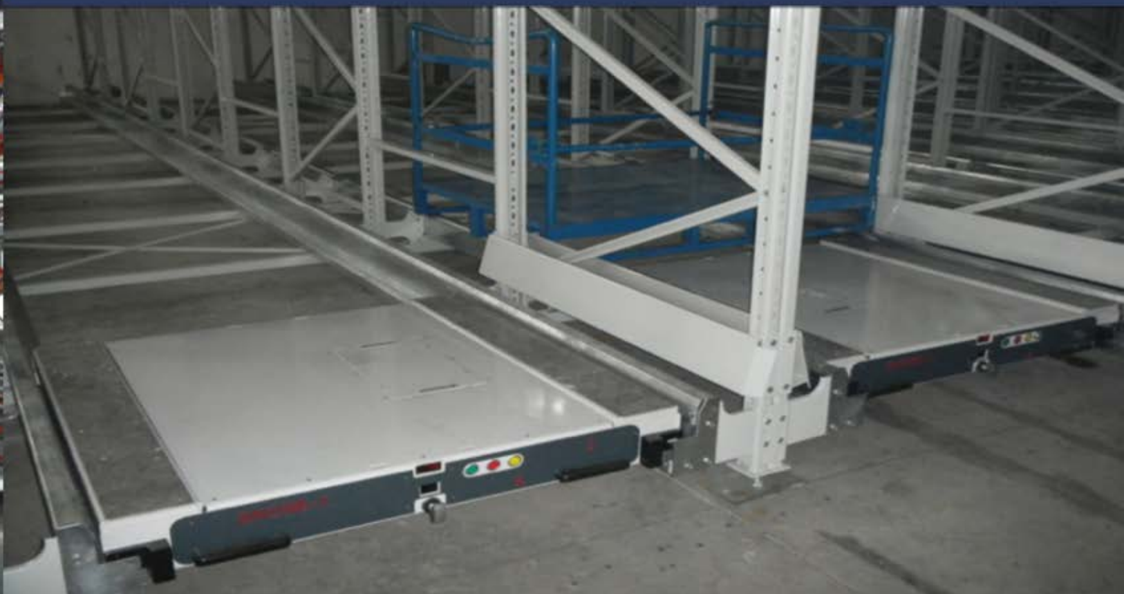
SHUTTLES DE BAJA TEMPERATURA + MONTACARGA, ALMACÉN SEMIAUTOMÁTICO
