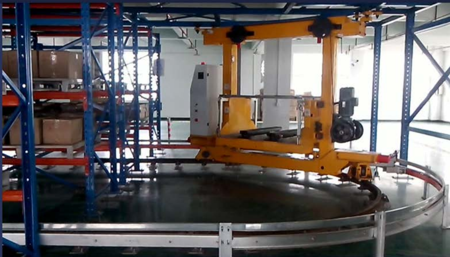
TRANSELEVADOR DE DOBLE COLUMNA Y CAMBIO DE VÍAS, ALMACÉN AUTOMATIZADO.
