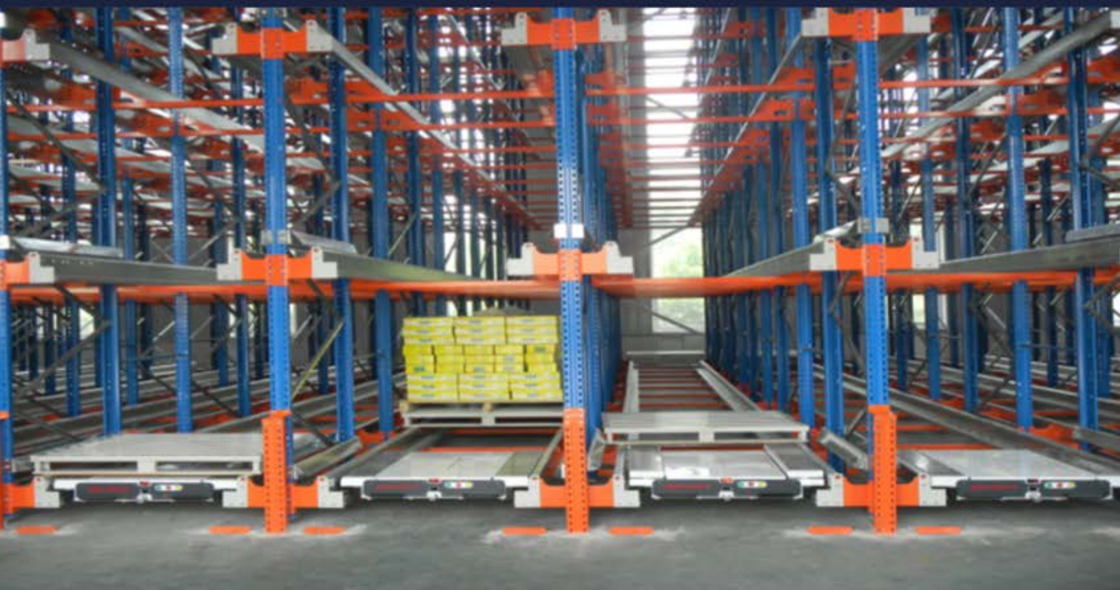
SOLUCIÓN TRADICIONAL: SHUTTLE + MONTACARGA, ALMACÉN SEMIAUTOMÁTICO
