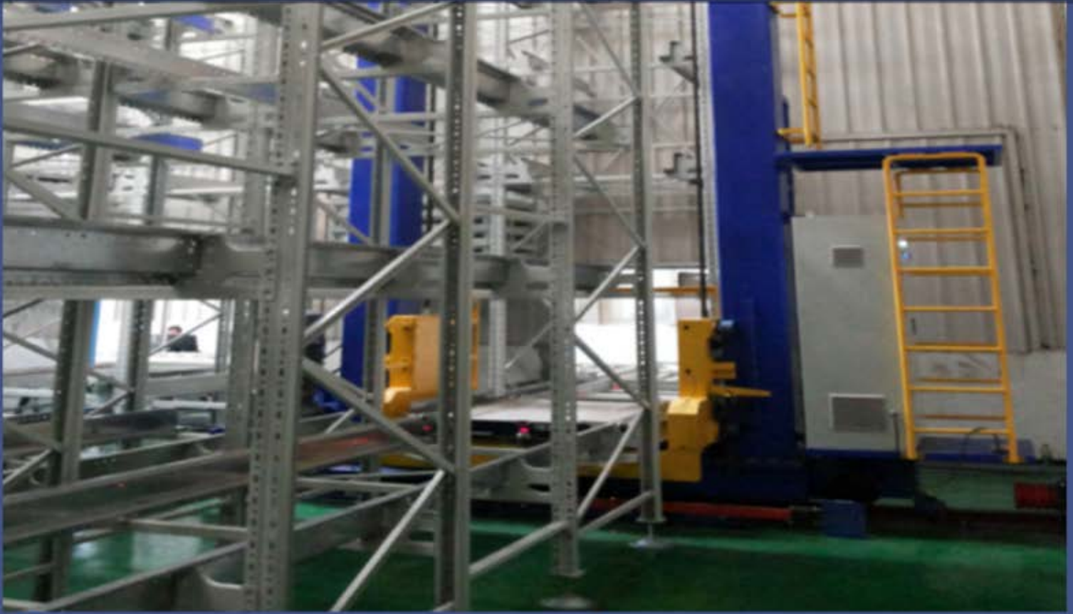
TRANSELEVADOR DE DOBLE COLUMNA + SHUTTLE, ALMACÉN AUTOMATIZADO.
