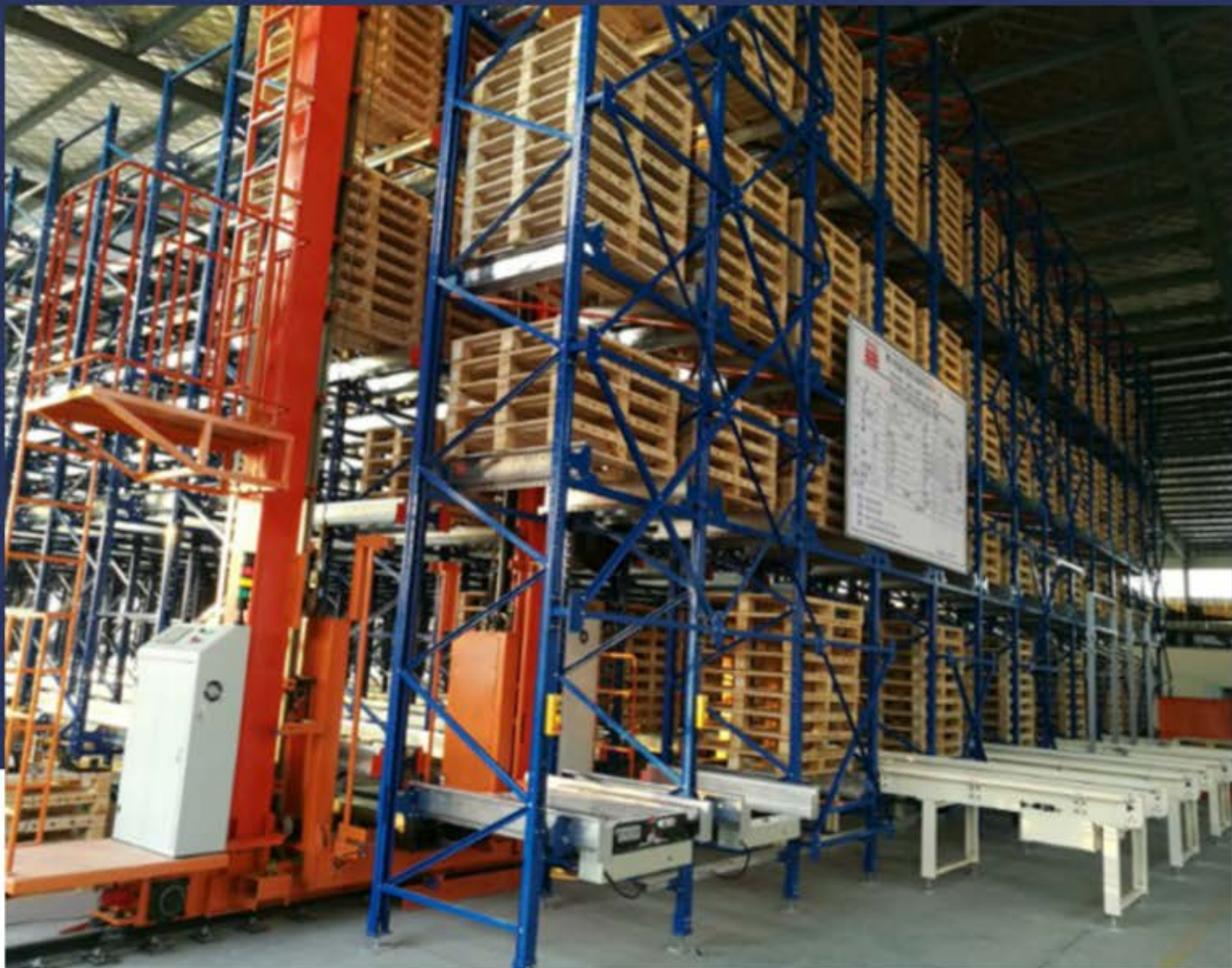
TRANSELEVADOR DE DOBLE COLUMNA + SHUTTLE, ALMACÉN AUTOMATIZADO.
